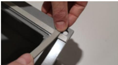
2. Auf die Stirnflächen chemisch beständiges Dichtungsband an der Innenkante parallel bündig zur Flanschseite aufkleben.
