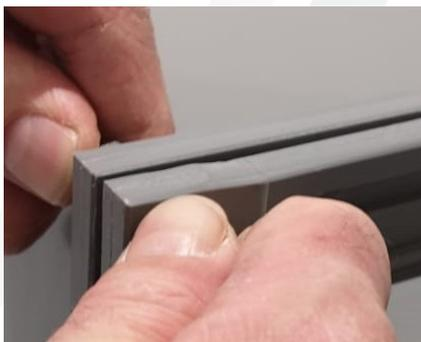
6. Vor dem Verschrauben müssen die Flansche planparallel ausgerichtet werden. Bei der Montage darauf achten, dass die Dichtung nicht verschoben wird.
