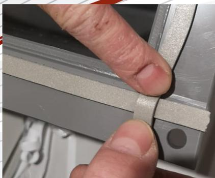
3. Das Dichtungsband muss an den Ecken über Kreuz geklebt werden.
