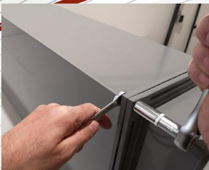
9. Anschließend die Eckschrauben erneut mit 14 Nm anziehen.
