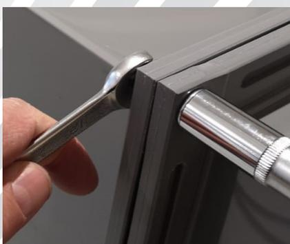
7. Die Sechskantschraube DIN 6921 M8 x 35 und Sechskantmutter DIN 6923 M8 mit 14 Nm fest anziehen.
