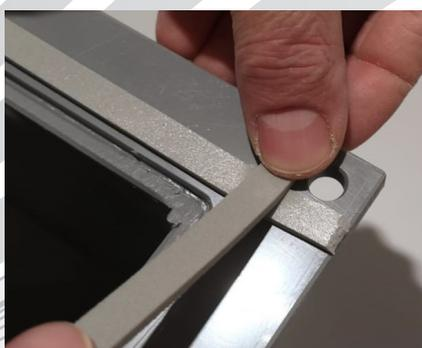
2. Auf die Stirnflächen chemisch beständiges Dichtungsband an der Innenkante parallel bündig zur Flanschkante aufkleben.
